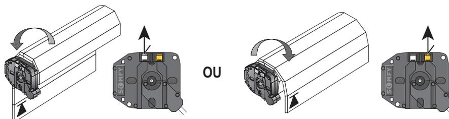
Appuyer simultanément sur les touches ▲ et ▼ jusqu'au va-et-vient du moteur pour sortir du mode réglage moteur.
